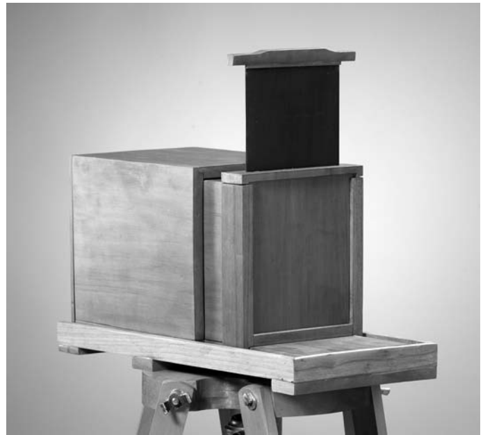
Hipotetična rekonstrukcija fotografske kamere Janeza Puharja (izrez na hrbtni strani z vstavljenjo svetlobotesno kaseto; odprta svetlobna zapora); vir: fototeka Grafičnega kabineta NMS).
